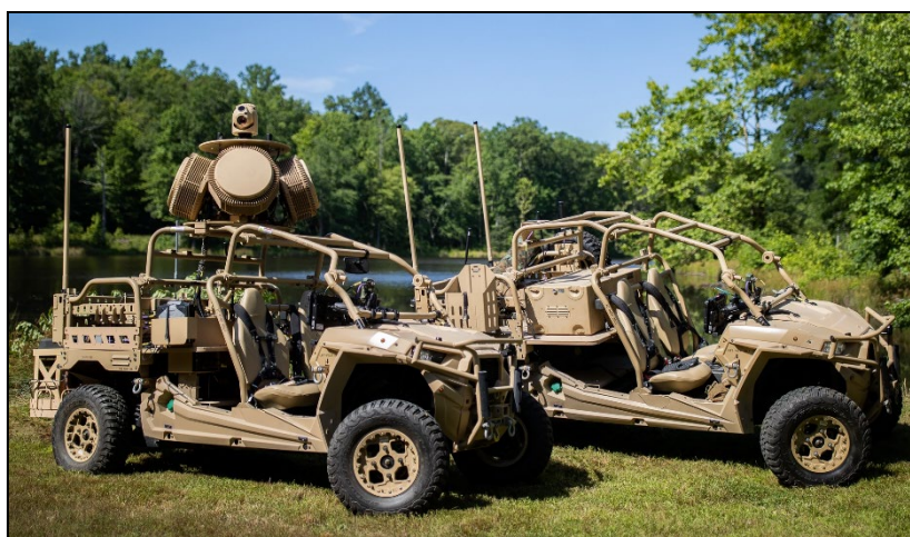
Fig. nr. 9 Sistemul american integrat ultra-ușor de combatere a dronelor bazat pe tehnologie de bruij L-MADIS - Light-Marine Air Defense Integrated System
