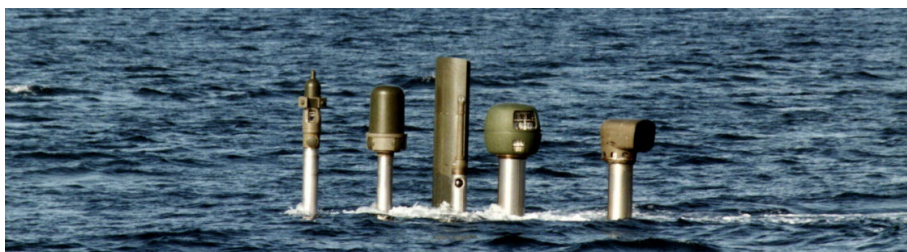
Fig. nr. 2 Antene de comunicații la submarine
