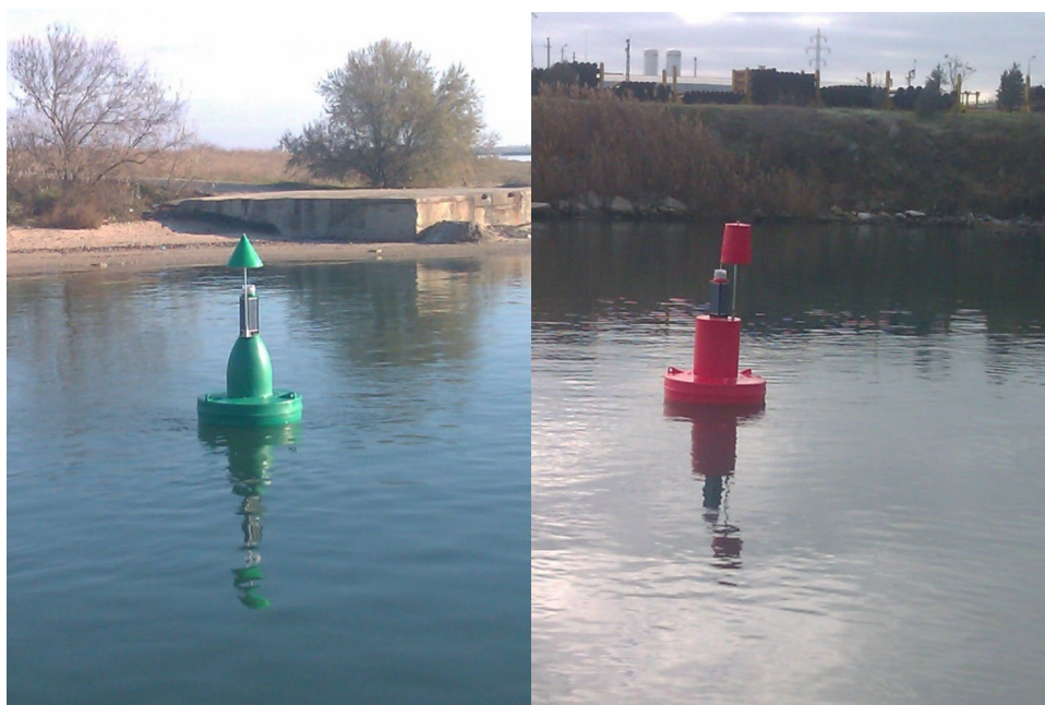
Fig. 2 Geamanduri cu semnalizare luminoasă folosite pentru balizarea Portului Mangalia
