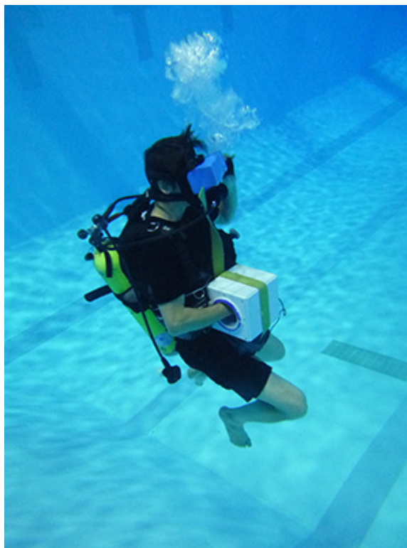
Fig. nr. 6: Mască facială pentru scafandru cu dispozitivul VR [6]
