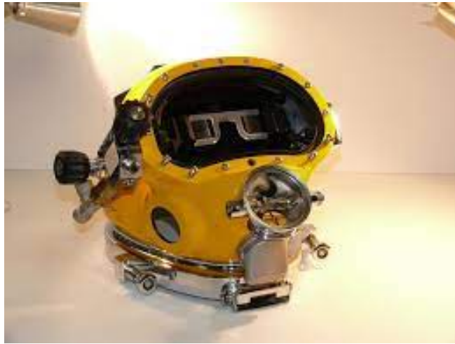
Fig. nr. 7: Casca Kirby Morgan – 37 cu dispozitivul de afișaj digital [7]
