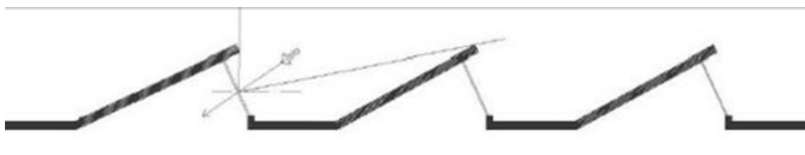
Fig.1.2 e Captator înclinat și reflector puțin înclinat
